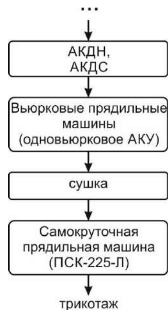
Рис. Технология выработки крученой пряжи
