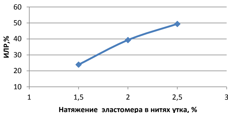
Рис. 2. Зависимость ИЛР ткани по утку от натяжения эластомера при производстве ткани
